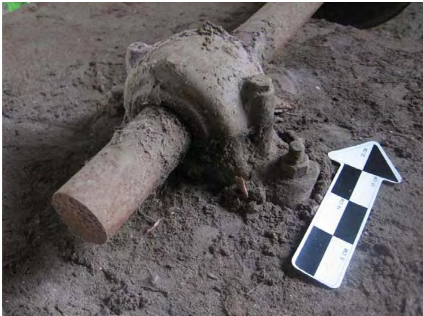
Fotografía 4. Subsistema de Transmisión de Energía. Árbol de Poleas #3. Chumacera #3.
