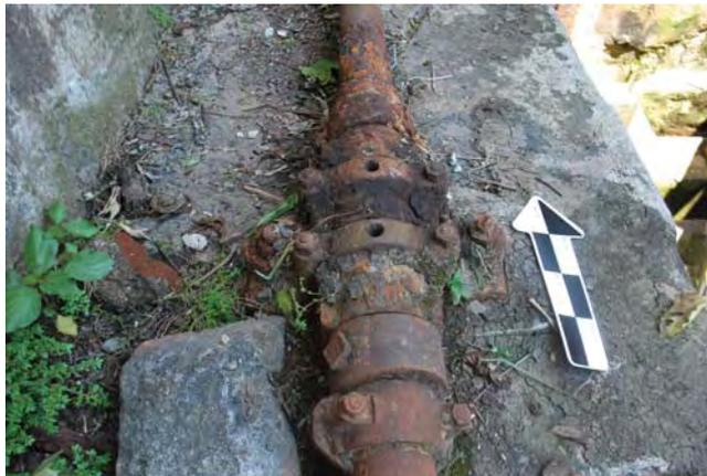
Fotografía 5. Subsistema de Transmisión de Energía. Árbol de Poleas #2. Chumaceras #2, Vista Frontal.
