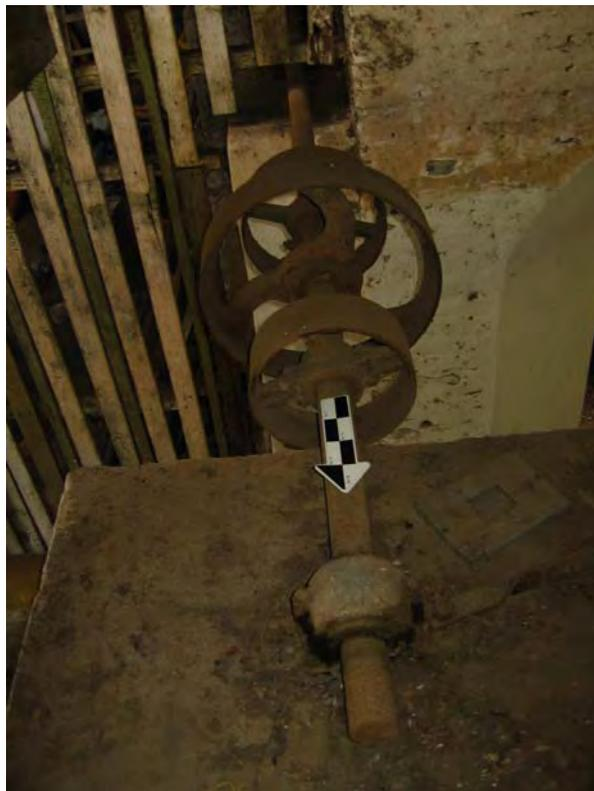
Fotografía 2. Subsistema de Transmisión de Energía. Árbol de Poleas #3. Vista: Posterior.
