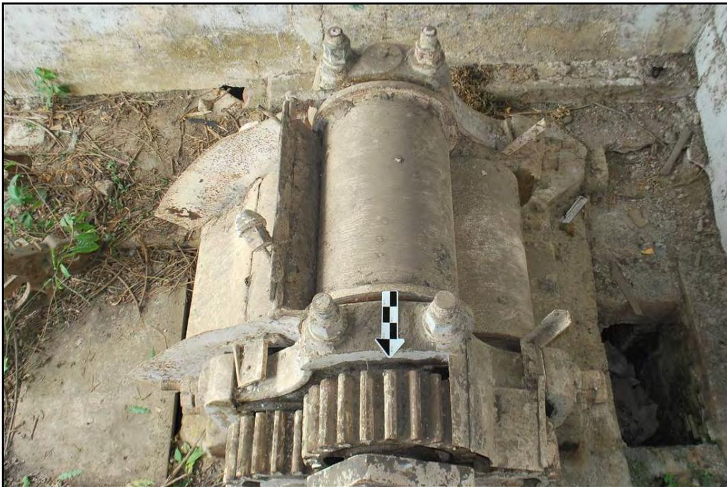
Fotografía 1. Molino de caña. Subsistema de molienda.
