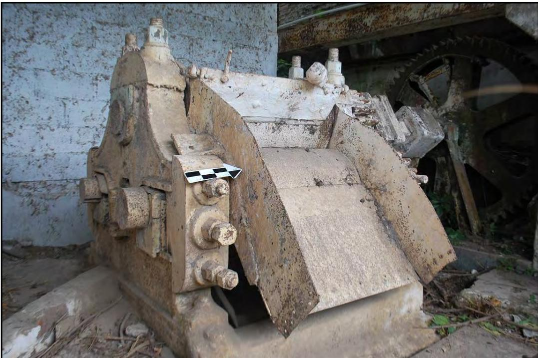
Fotografía 3. Molino de caña. Subsistema de molienda.
