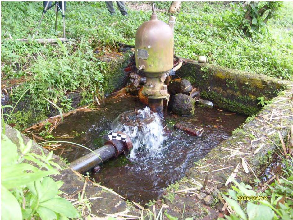
Fotografía 4. Sistema Bomba de Ariete Hidráulico. Vista: Isométrico Frontal Derecho.
