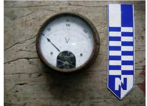
Fotografía 8. Voltímetro Analógico.
