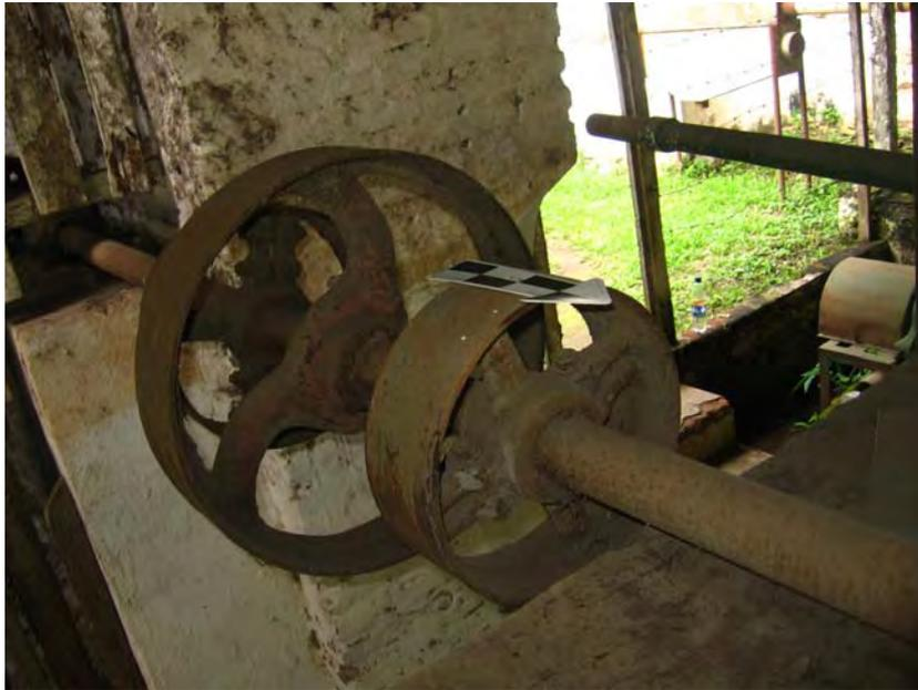
Fotografía 3. Subsistema de Transmisión de Energía. Árbol de Poleas #3. Poleas 1, 2 y 3.
