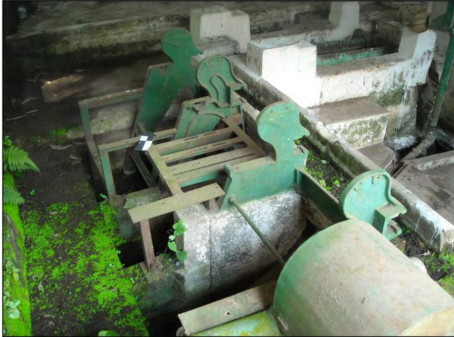
Fotografía 1. Subsistema de despulpado. Vista: isométrico posterior izquierdo.
