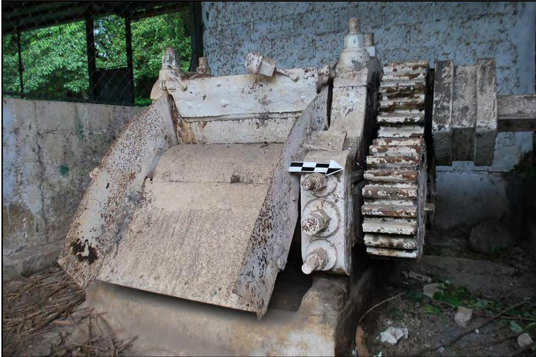
Fotografía 2. Molino de caña. Subsistema de molienda.
