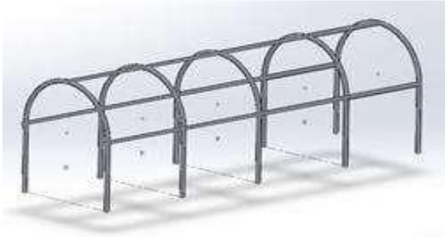
Figura 2. Diseño en 3D de la estructura plegada.
