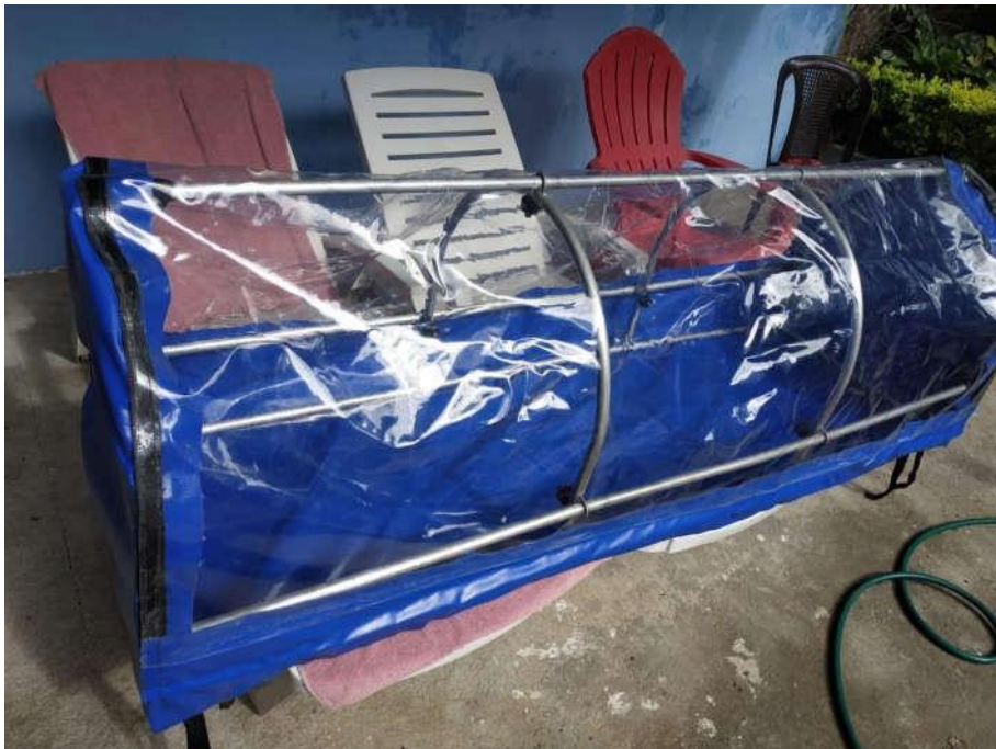
Figura 15. Modelo EIM-2. Proceso de incorporación de la lona y el plástico.
