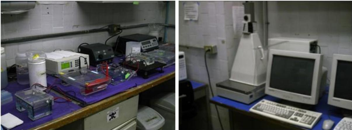
**Figura 8.** A la izquierda, cámaras de electroforesis y a la derecha un transiluminador de luz ultravioleta para visualización del ADN marcado con bromuro de etidio.
