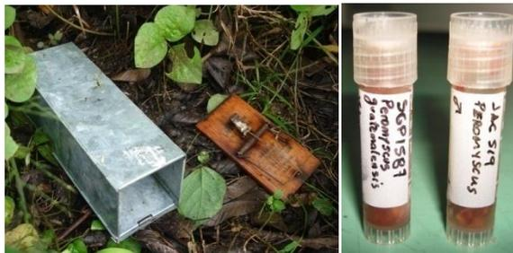
**Figura 4:** Equipo de campo: trampas Sherman y de golpe para la captura de ratones (izquierda) y viales para la preservación de tejidos en el campo (derecha).
