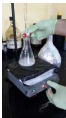
Imagen 10. Titulación del ion cianuro con el método de Liebig.
