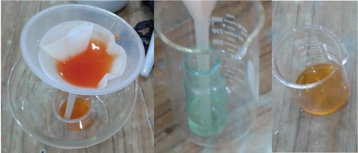
Foto No. 4 Filtrado de extracto para obtener los carotenoides
